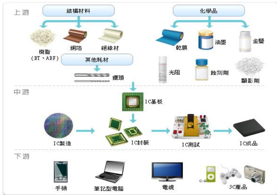
資料來源：Money DJ 理財網， http://www.moneydj.com 。 圖一 IC 載板產業關聯圖
